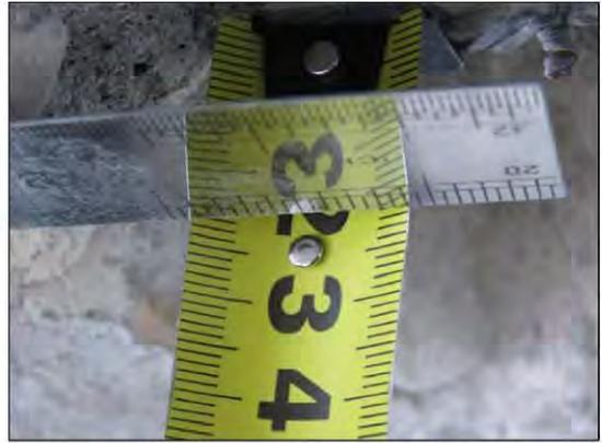
ФОТО 22. Уточнение защитного слоя бетона монолитной ж/б стены 1-го этажа между осями «2с4»-«3с4» и «Bc4»-«Гс4».
