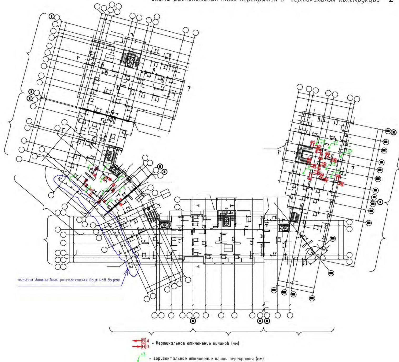
Рис. 3. Отклонения от вертикали и горизонтали несущих монолитных железобетонных конструкций 2-го этажа
