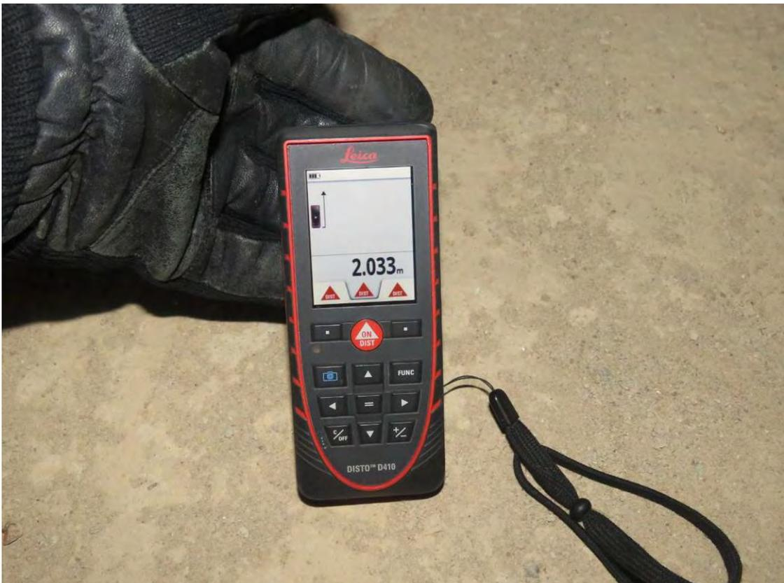
**Рис. 2.4. Замер высоты помещений подвального этажа секции №1 между осями 4с1-3с1, Кс1-Вс1 при помощи лазерного дальномера Leica DISTO D410**
