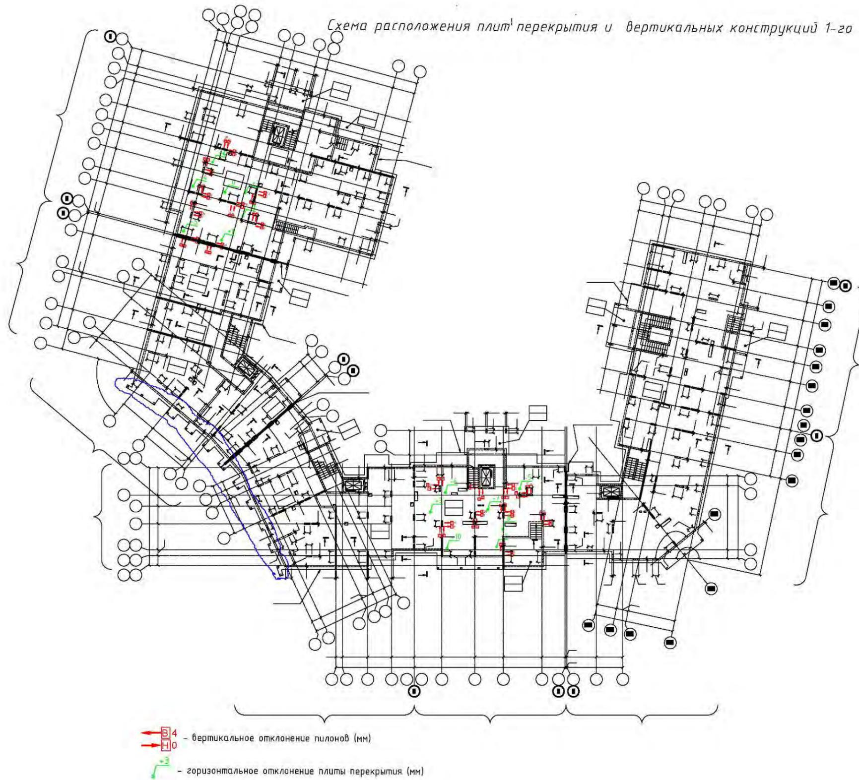
Рис. 2. Отклонения от вертикали и горизонтали несущих монолитных железобетонных конструкций 1-го этажа
