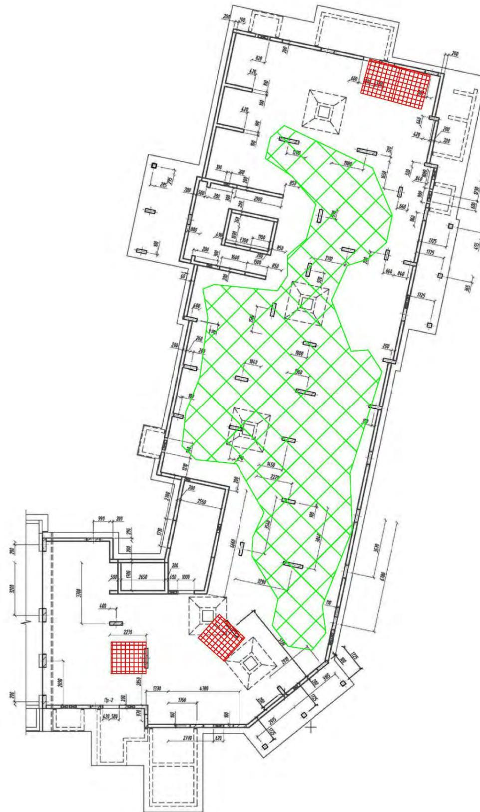
**Рис. 4. Схема расположения дефектов конструкций подвала 5 и 6 секции.**
