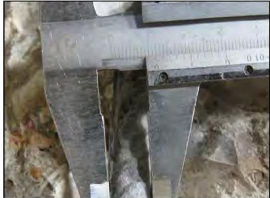
ФОТО 2. Уточнение диаметра рабочей арматуры монолитного ж/б пилона подвала по оси «Гс3» между осями «бс3» и «Гс3».
