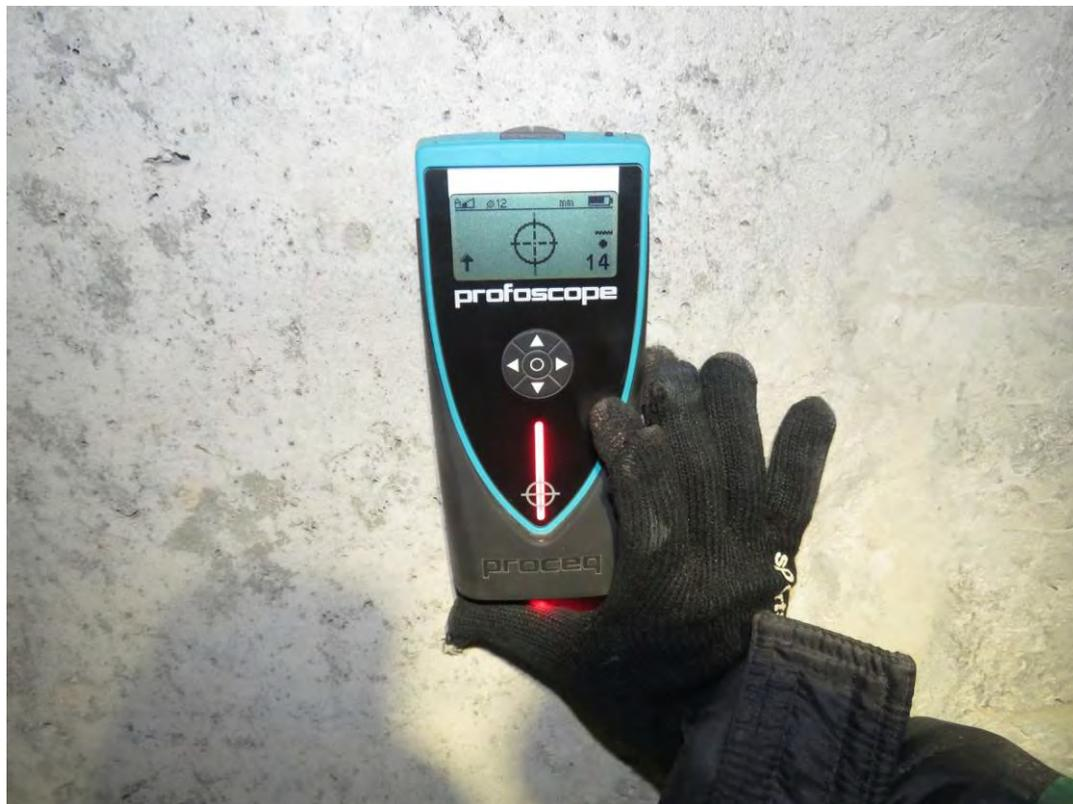
**Рис. 3.2.5. Определение расположения армирования и толщины защитного слоя бетона выполнено при помощи магнитного прибора «Profoscope» по оси Гс1 между осями 7с1-8с1 на отм. -3,300 м секции 1**
