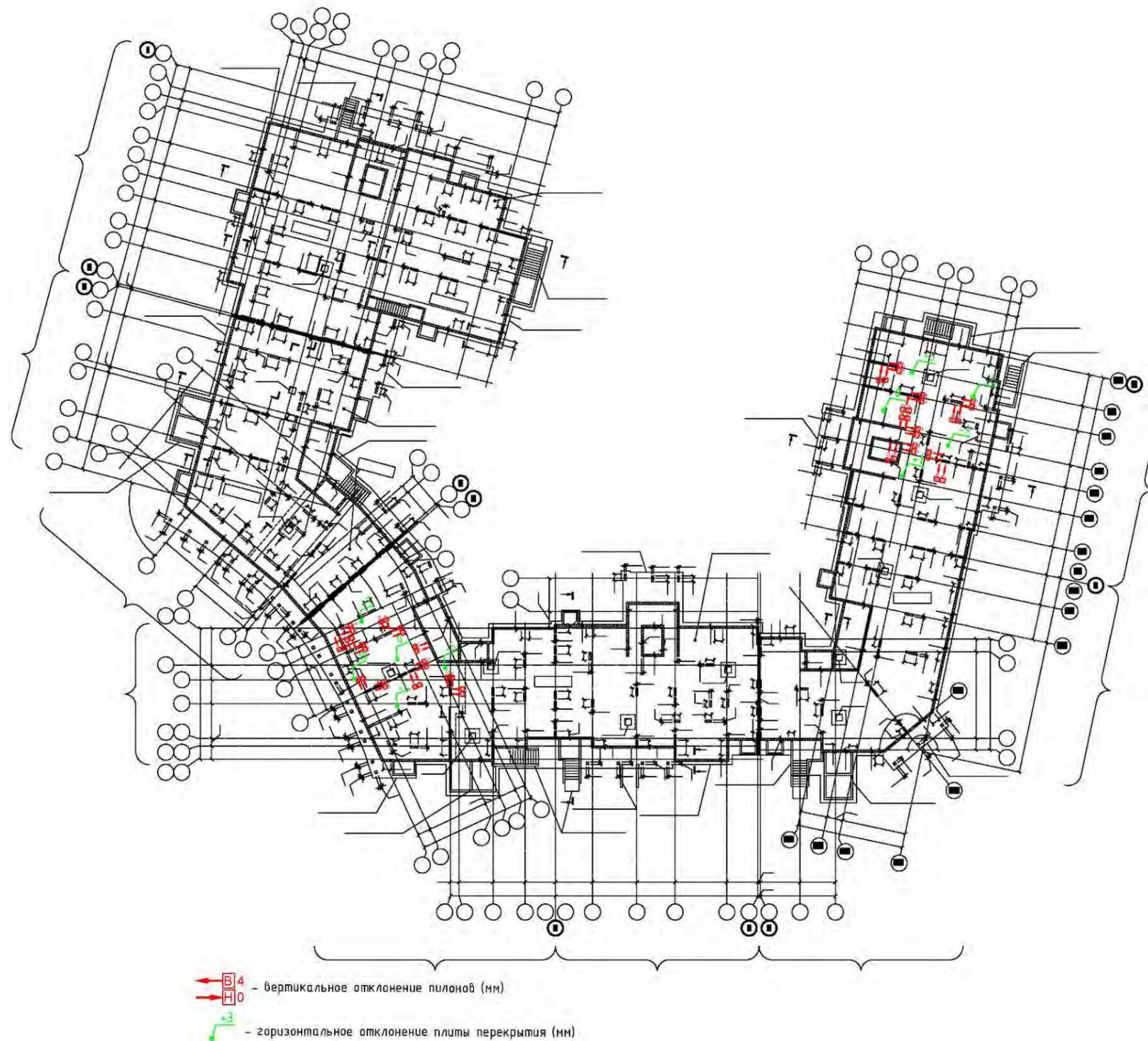
Рис. 1. Отклонения от вертикали и горизонтали несущих монолитных железобетонных конструкций подвала.
