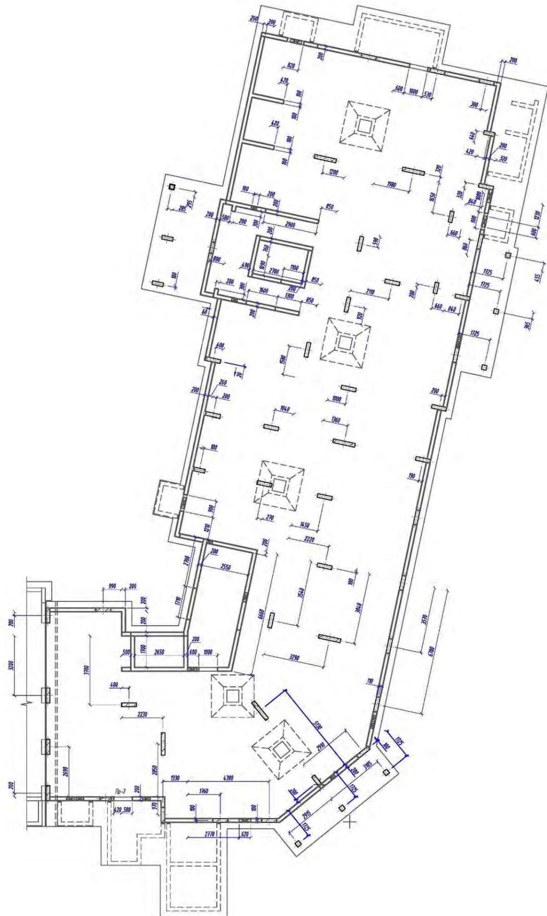
Рис. 8. План 1-го этажа с фактическими смонтированными несущими конструкциями секции 5. 6.
