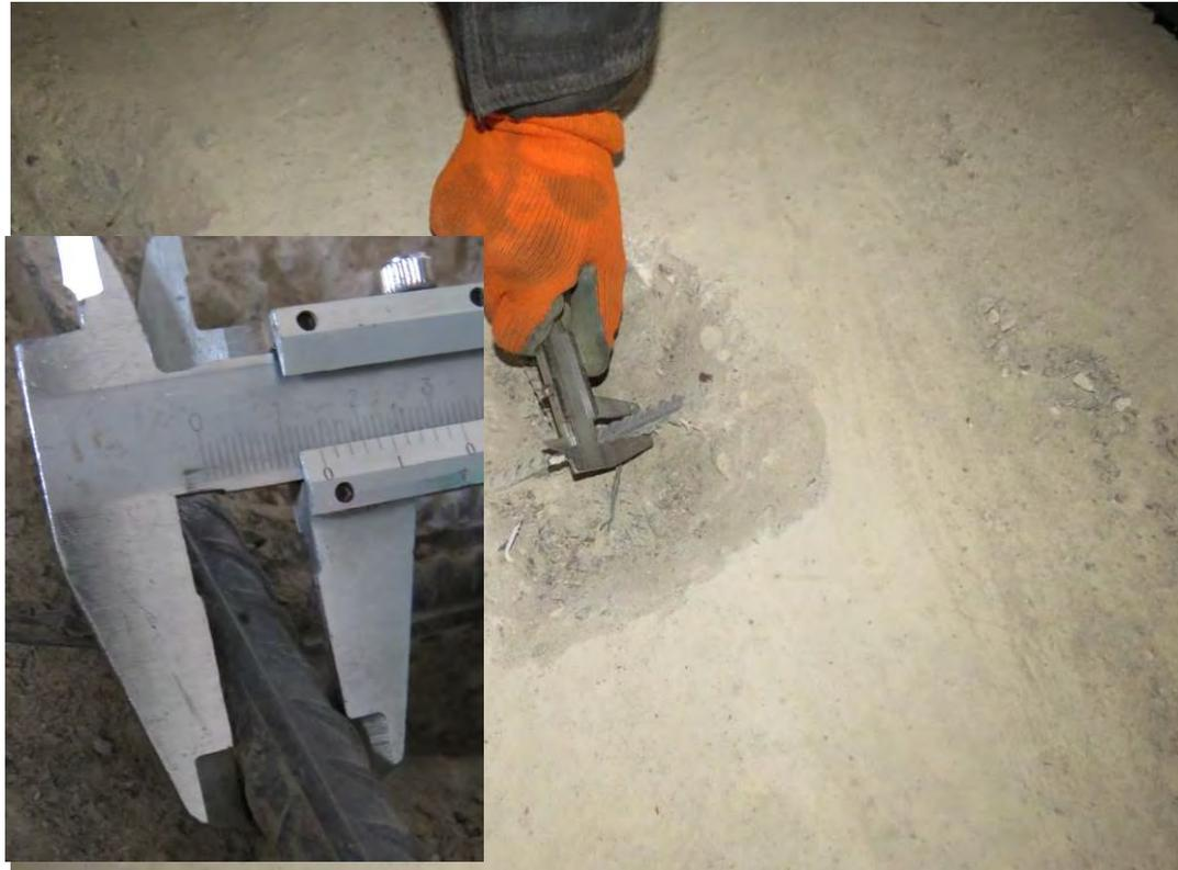
**Рис. 3.1.7. Определение диаметра (14 мм) арматуры верхней зоны армирования фундаментной плиты секции 3 между осями 13с3-14с3, Бс3-Вс3**
