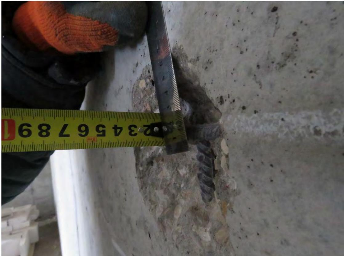
Рис. 3.2.4. Замер толщины защитного слоя монолитной ж.б. стены по оси Гс4 между осями 13с3-14с3 на отм. -3,300 м
