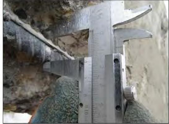
ФОТО 26. Уточнение диаметра рабочей арматуры монолитной ж/б колонны 1-го этажа по оси «Ас3/1» и «3с4».
