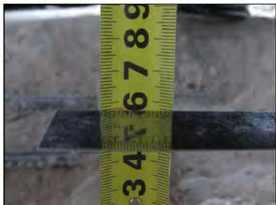
ФОТО 4. Уточнение защитного слоя бетона напольной поверхности монолитной ж/б фундаментной плиты расположенной между осями «12с3»-«13с3» и «Вс3»-«Гс3».
